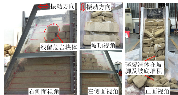
(d) 阶段4: 滑体下滑堆积、坡体失稳破坏
