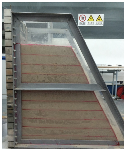
图 2 制作完成的水平层状岩质边坡模型
